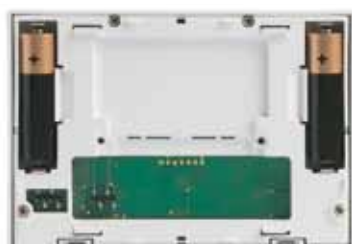
Vista interna del cronotermostato, dal retro, con alloggiamento batterie
